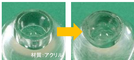
図 9. 熱による二次光学レンズの変形例
